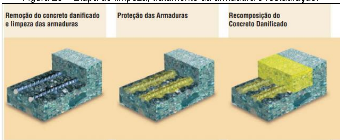
Figura 28 – Etapa de limpeza, tratamento da armadura e restauração.
